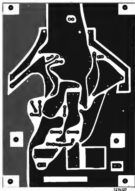
Fig. 5 - Circuito stampato tipo B per la realizzazione degli amplificatori 3, 4, 5, visto dalla parte del rame.
