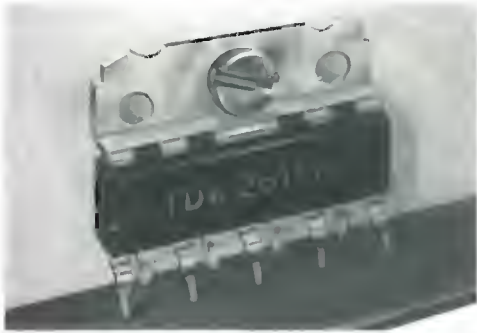
Fig. 8 - Sistema di montaggio N. 4
