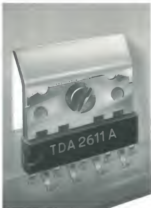
Fig. 7 - Sistema di montaggio N. 3
